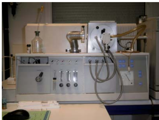
Fig. 76: Fotografía del espectrómetro de masas de baja resolución MICROMASS, tomada en el Centro de Instrumentalización Científica de la Universidad de Granada (la autora).
