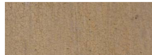
Fig. 105: Enlucido con acabado liso lavado (la autora).
