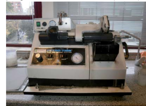
Fig. 72: Fotografía de la Cortadora y desbastadora Petro-Thin, tomada en el laboratorio de mineralogía y petrografía de la Universidad de Granada (la autora).
