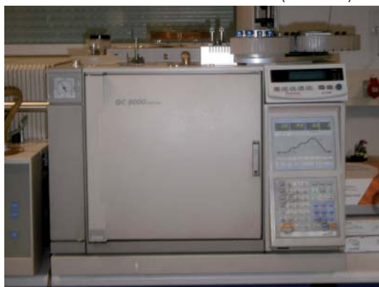
Fig. 77: Fotografía del cromatógrafo de gases CARLO ERBA, tomada en el Centro de Instrumentalización Científica de la Universidad de Granada (la autora).
