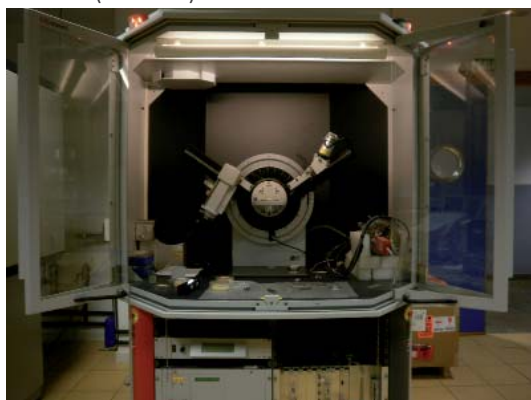
Fig. 70: Fotografía del Difractómetro de polvo BRUKER D8 ADVANCE, tomada en el Centro de Instrumentalización Científica de la Universidad de Granada (la autora).
