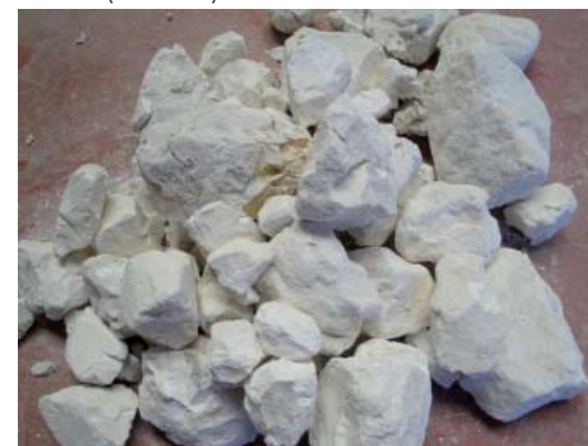
Fig. 36: Fotografía de trozos de caliza antes de su cocción (la autora).
